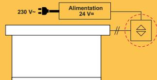
**M8** Moteur autonome avec batterie intégrée au moteur. Autonomie moyenne 300 cycles avant rechargement. Application gratuite (Apple ou Android). Lg 625 mm mini – 5 m<sup>2</sup> maxi.
