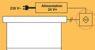
**M6** Moteur avec récepteur RTS déporté et alimentation power 1.5 déporté. Lg. 390 mm mini.
