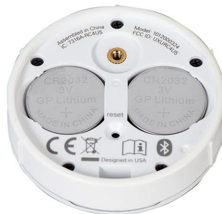
1. Pour la télécommande PowerView® Gen 3 avec Pebble®, glissez votre pouce dans l'encoche, soulevez délicatement et retirez le module de télécommande du Pebble®. Pour la télécommande PowerView® Gen 3 avec support mural, retirez le support mural de sa plaque de montage en la tournant dans le sens inverse des aiguilles d'une montre. Poussez le module de télécommande hors du support mural depuis l'arrière.
