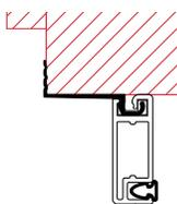
La moustiquaire vient s'insérer dans l'ouverture de la fenêtre.
