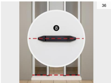
Plaque de sol. Dégraisser et sécher la surface de fixation avant de coller l'adhésif double face : l'adhésion complète est obtenue au bout d'au moins 24 heures.
