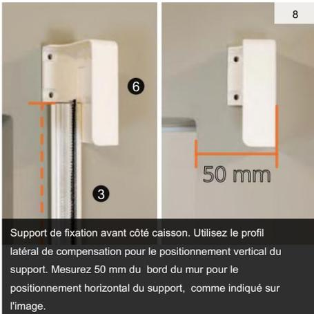
Support de fixation avant côté caisson. Utilisez le profil latéral de compensation pour le positionnement vertical du support. Mesurez 50 mm du bord du mur pour le positionnement horizontal du support, comme indiqué sur l'image.
