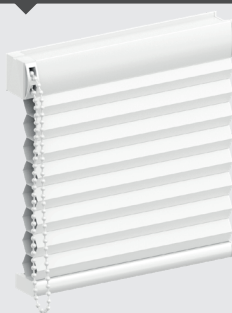
M3 Manœuvre chaînette Bloc manœuvre détachable pour la sécurité enfant. Guidage impossible pour les toiles plis de 32 mm. Profil haut : lg 29 mm x ht 34 mm. Lg mini 500 mm. Ht mini 500 mm. Surface maxi 6 m 2 ou 7 m 2 selon toiles.
