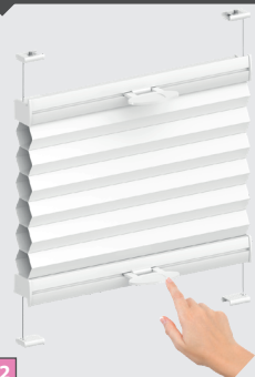
M2 Manœuvre manuelle en multizone Ouverture par le haut ou par le bas. Toiles en plis de 20 mm ou 25 mm uniquement. Profil haut et ba : lg. 22 mm x ht. 20 mm. Lg. maxi 1300 mm. Ht. maxi 2300 mm.
