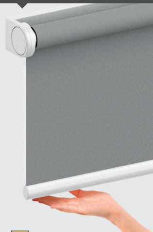
M4 LiteRise® Inclus support SD46, tube 37 mm, barre de charge déco et poignée transparente. Guidage impossible. Lg mini 700 mm. Lg mini 1500 mm en toiles transparentes. Hauteur maximum conseillée 2100 mm. La préconisation doit tenir compte de la taille de la personne qui manipule le store.
